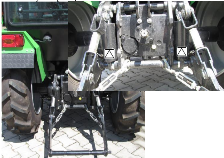
umístění zvedáku v zadní části traktoru pod okem hydraulického válce
