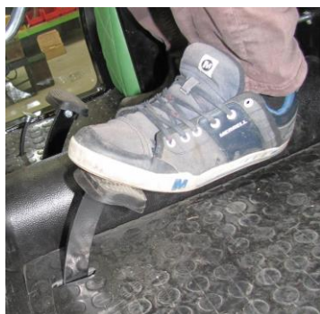
Uvolněná spojka, umožňuje pojezd i pohon PTO
