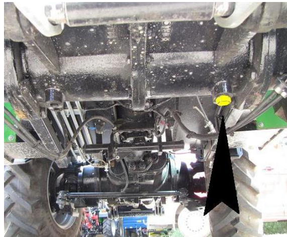
vypouštěcí šroub zadní převodovky
