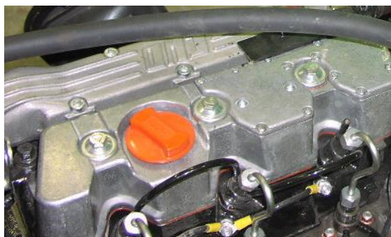
Plnicí hrdlo motorového oleje
