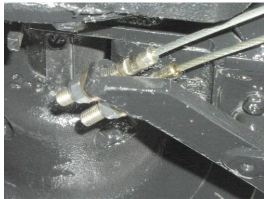
brzdový klíč, uložení provozní a parkovací brzdy
