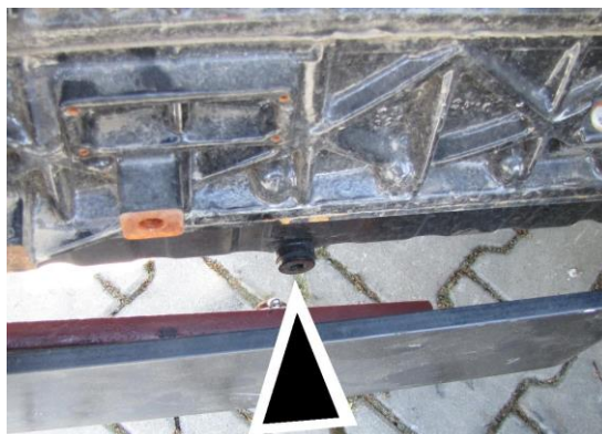
Vypouštěcí otvor motorového oleje
