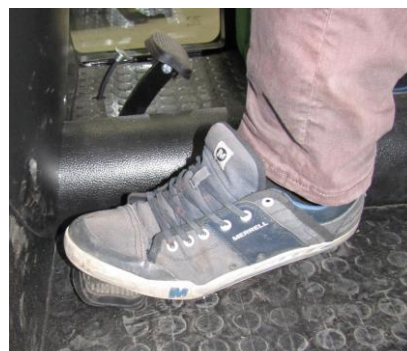
Plné vyšlápnutí spojky – úplné přerušování točivého momentu
