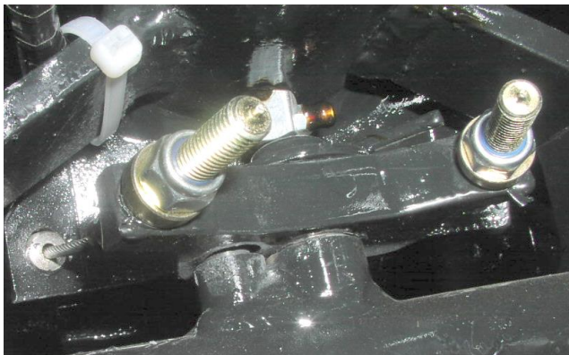
vahadlo pod převodovkou, lanka na jednotlivá kola
