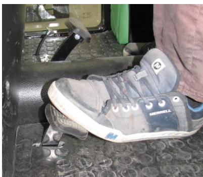
Poloviční zdvih – vypnutí pojezdu, pohon PTO zůstává v činnosti
