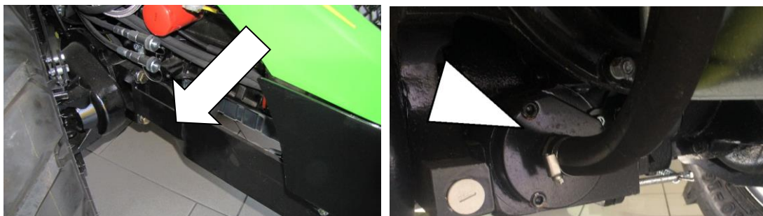
hydraulický filtr – mění se vložená patrona
