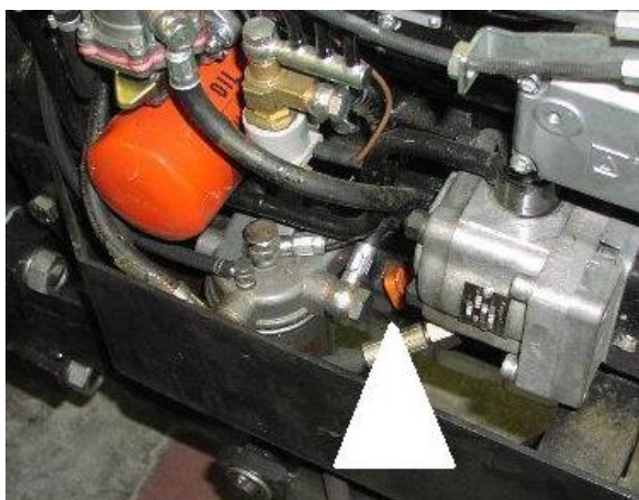
Měrka oleje motoru morotu Lombardini
