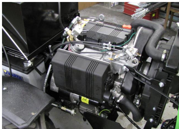
Vzduchový filtr plochý - filtr sání s suchou vložkou – mění se celá vložka
