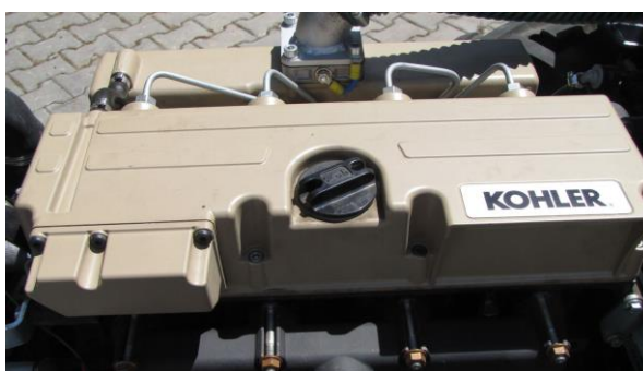
Plnicí hrdlo motorového oleje
