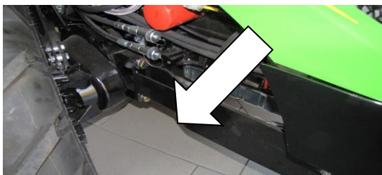
hydraulický filtr – mění se vložená patrona
