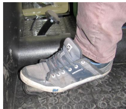
Plné vyšlápnutí spojky – úplné přerušování točivého momentu
