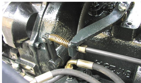
stavěcí šroub s matkou za páčkou spojkového ložiska
