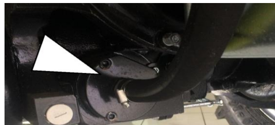
hydraulický filtr – mění se vložená patrona
