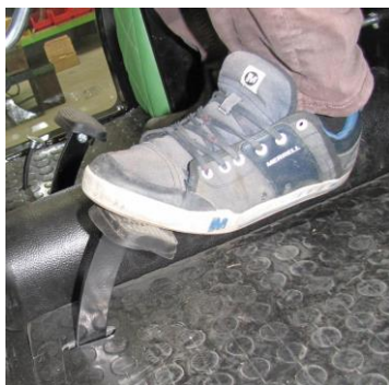
Uvolněná spojka, umožňuje pojezd i pohon PTO
