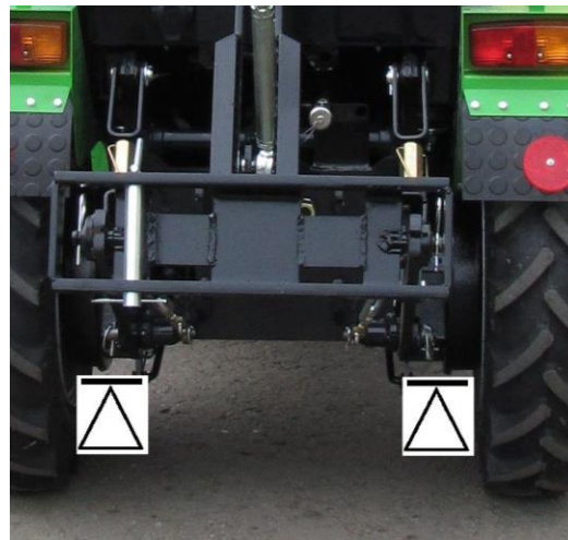
umístění zvedáku v zadní části traktoru pod koncové převody
