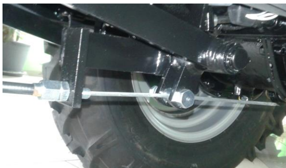
zavěšení lanka na spojkový pedál a zajištění svěrkou
