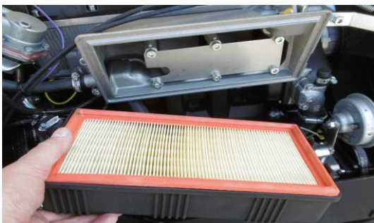
Vzduchový filtr - filtr sání s suchou vložkou – mění se celá vložka KDW 1404
