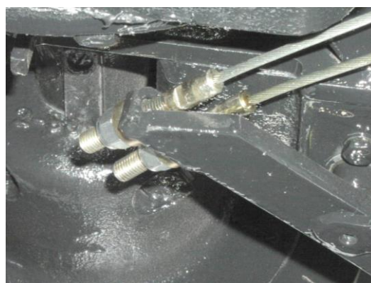
brzdový klíč, uložení provozní a parkovací brzdy
