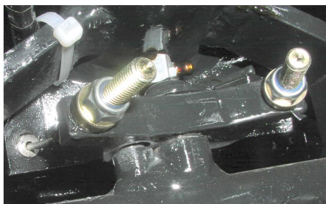
vahadlo pod převodovkou, lanka na jednotlivá kola
