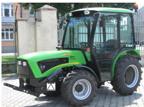
umístění zvedáku v přední části traktoru pod převodové skříň koncových převodů
