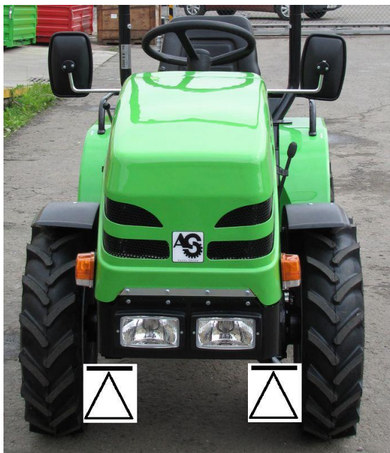
umístění zvedáku v přední části traktoru pod převodové skříň koncových převodů
