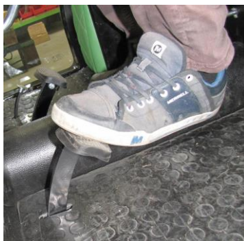
Uvolněná spojka, umožňuje pojezd i pohon PTO
