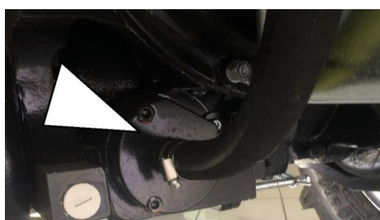
hydraulický filtr – mění se vložená patrona
