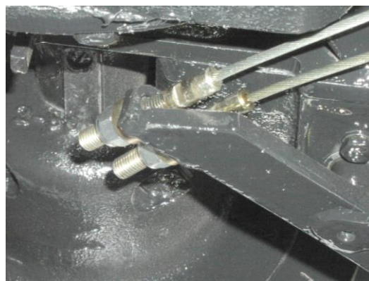
brzdový klíč, uložení provozní a parkovací brzdy
