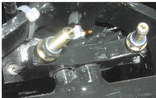
vahadlo pod převodovkou, lanka na jednotlivá kola
