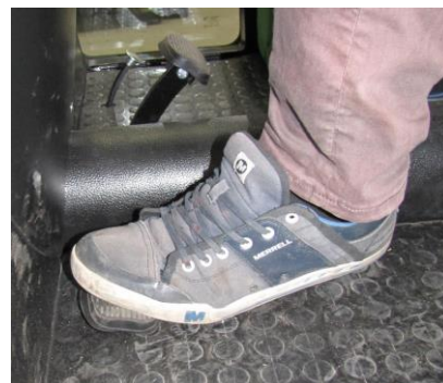
Plně vyšlápnutí spojky – úplné přerušování točivého momentu
